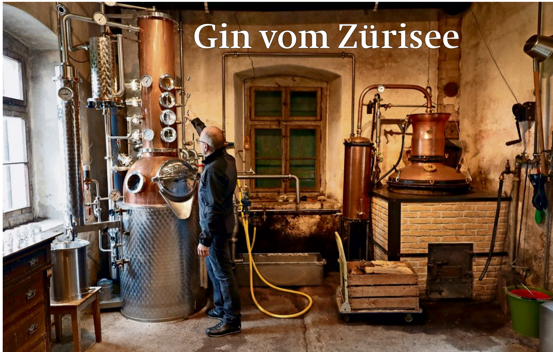
Urs Streuli kontrolliert den laufenden Gin-Brand am hochmodernen Kolonnen-Brennegerät – der alte Brennshafen daneben funktioniert nach einer Renovation jedoch auch noch.
